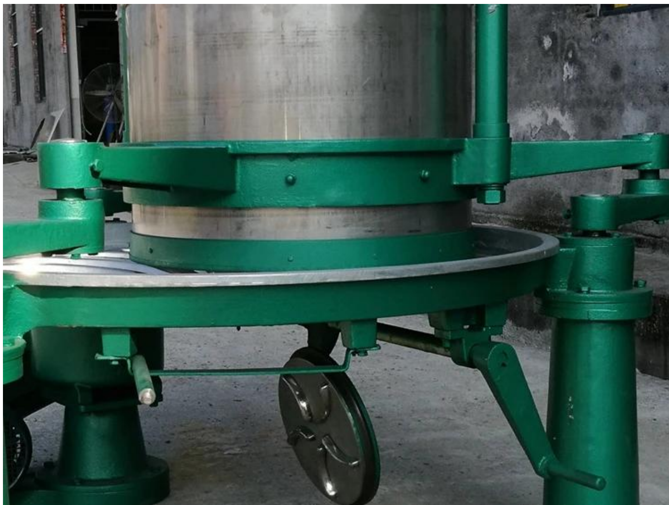
Phần đỡ của máy được làm bằng gang đúc chắc chắn và bền bỉ.
