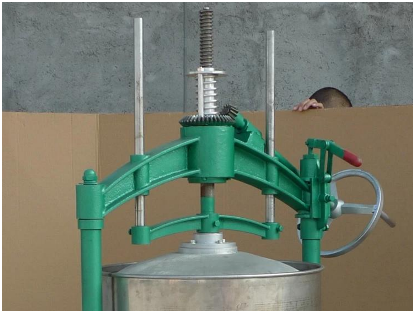
Tay đòn kép áp dụng kết cấu cánh kép mở nắp, có khả năng chịu lực và hoạt động ổn định.
