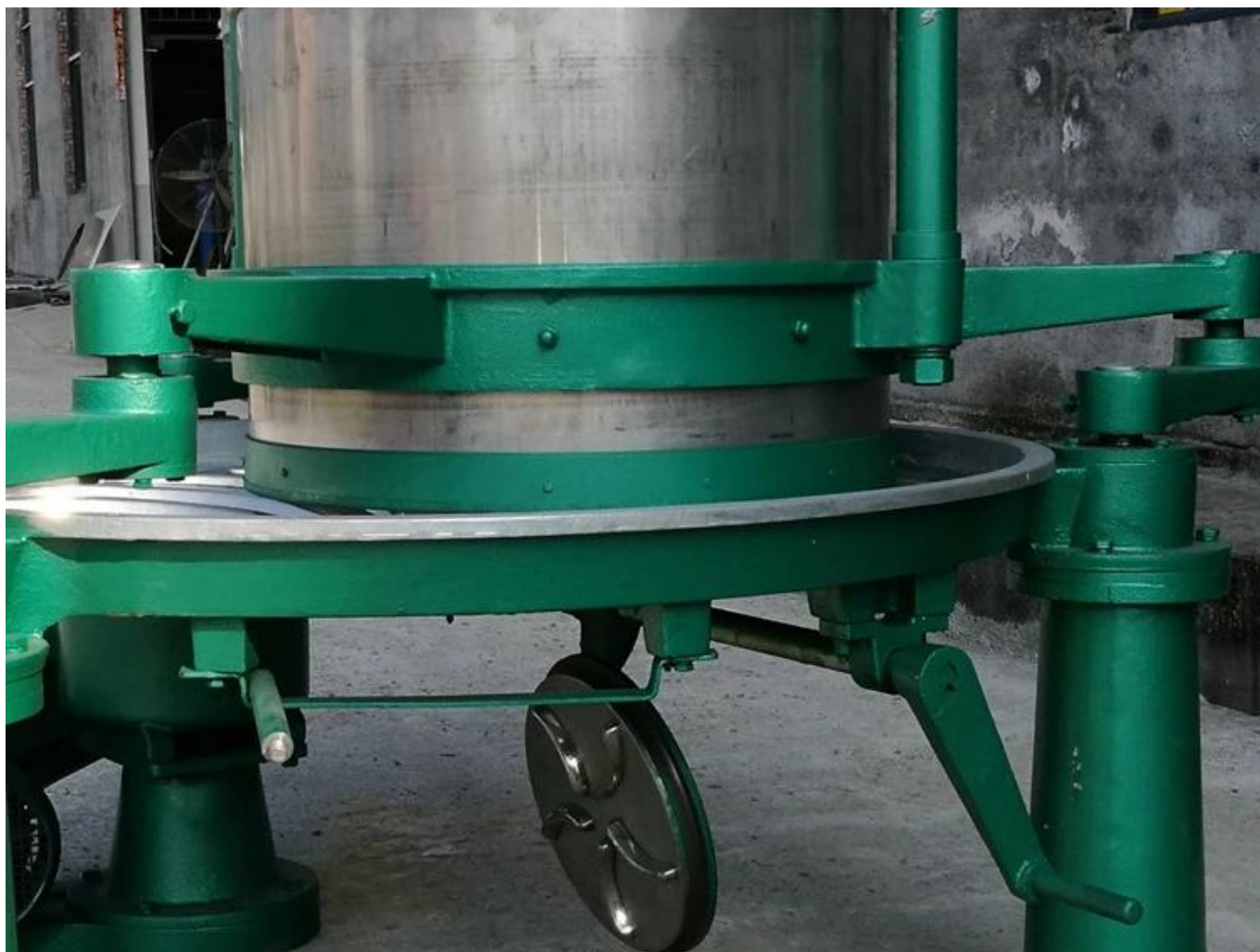
Bộ phận đỡ của máy được làm bằng gang đúc chắc chắn và bền bỉ.
